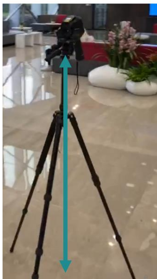
Doporučená výška instalace 1.5 m
